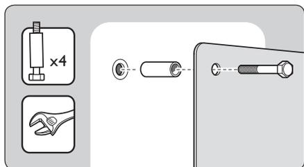
4. Затем следуйте инструкции, прилагаемой к настенному кронштейну VESA.
