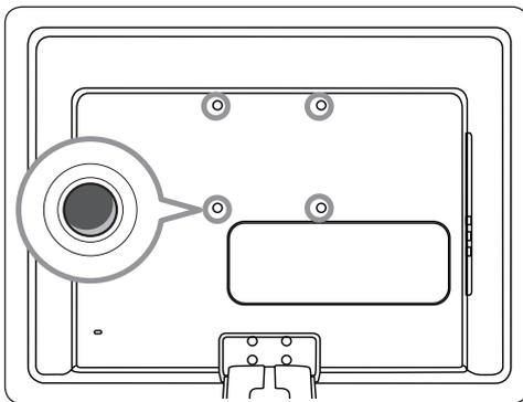
2. Установите крепежную пластинку/кронштейн под четырьмя местами крепления, при этом болты из комплекта поставки должны быть установлены между крепежной пластиной и местами крепления.
