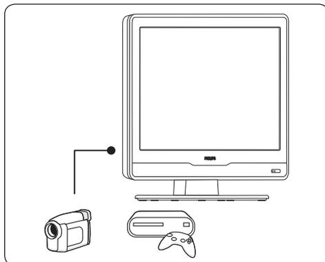
С помощью боковых разъемов подключайте мобильные устройства, например видеокамеру высокой четкости или игровую приставку. Также можно подсоединить пару наушников.
