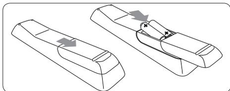
2. Вставьте два прилагаемых элемента питания (размер AAA, тип LR03). Установите элементы питания, соблюдая полярность (отметки "+" и "-" внутри отсека).
