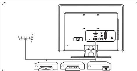
С помощью разъемов на задней панели телевизора подключайте антенну и постоянные устройства, например проигрыватель компакт-дисков, DVD-плеер или рекордер.
