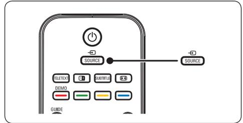
3. Нажмите **▲** или **▼** для выбора входа, к которому подключено внешнее устройство.
