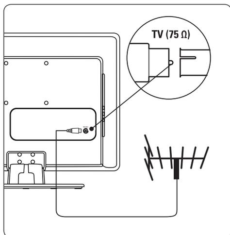
2. Вставьте один конец кабеля антенны (не входит в комплект подставки) в разъем **TV ANTENNA**. Если антенну невозможно подключить к разъему, используйте адаптер.
