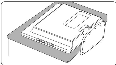
2. При помощи крестообразной отвертки (не входит в комплект) отвинтите 4 винта, которые закрепляют телевизор на подставке (четыре болта для экранов с диагональю 19", три болта для экранов с диагональю 22").
