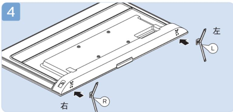
\*将底座按照图示对齐放置(注意区分左右支撑), R、L在底座上有标识； 7
