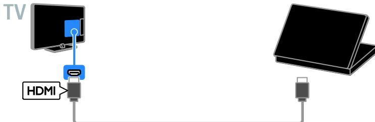
**(Само за определени системи.)** Свържете компютъра с телевизора посредством DVI-HDMI кабел и аудио кабел.
