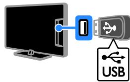
Свържете USB флеш устройството с телевизора посредством USB кабел.
