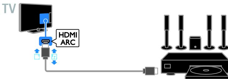
Свържете системата за домашно кино с телевизора посредством HDMI кабел и оптичен аудио кабел.
