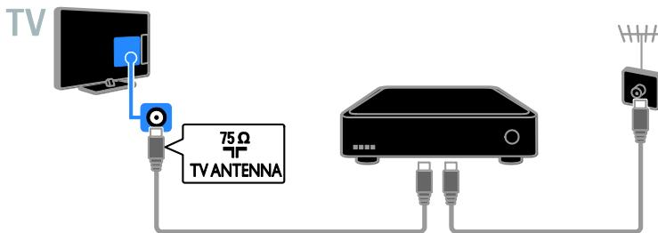
Свържете цифровия телевизионен приемник с телевизора посредством HDMI кабел.
