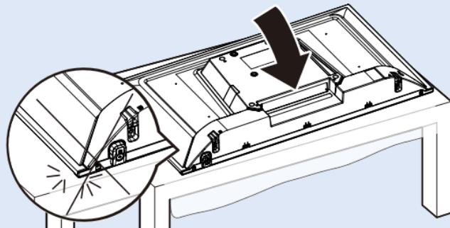
\*请将电视机底部边缘靠近台面边缘，将下巴放置于台面外。
