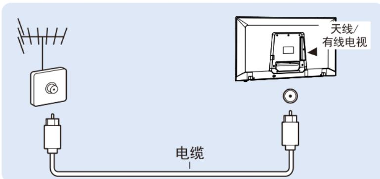
备注：由于用户装修时电源的地线与有线信号的地线电压有差异，可能造成有线信号与电视机连接处会有发热的情况，情况严重时会导致事故发生，为了避免不安全事故的发生及提高观看电视的安全性，电视机内置集成天线隔离器。
