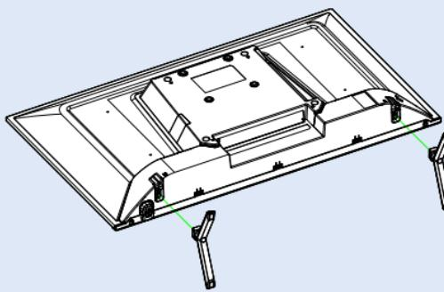
\*将底座按照图示对齐放置(40/43")注意区分左右支撑)。
