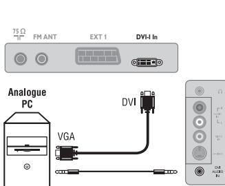
**Оптимальное разрешение экрана получается, когда для компьютера выбраны настройки 1024 x 768, 60 Hz.** Ниже приведен список различных настроек разрешения, которые можно использовать для отображения на этом телевизоре (в зависимости от версии):
