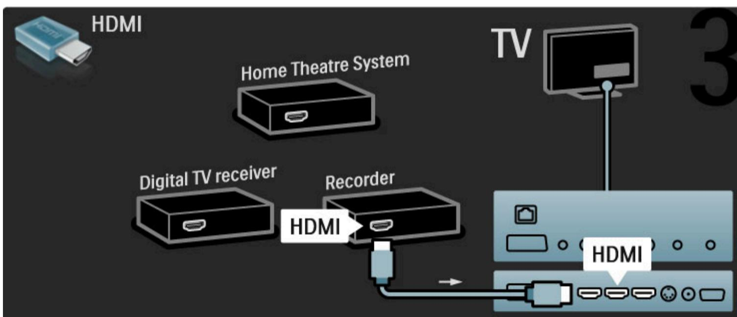
Potom pomocou kábla HDMI pripojte systém domáceho kina k televízoru.
