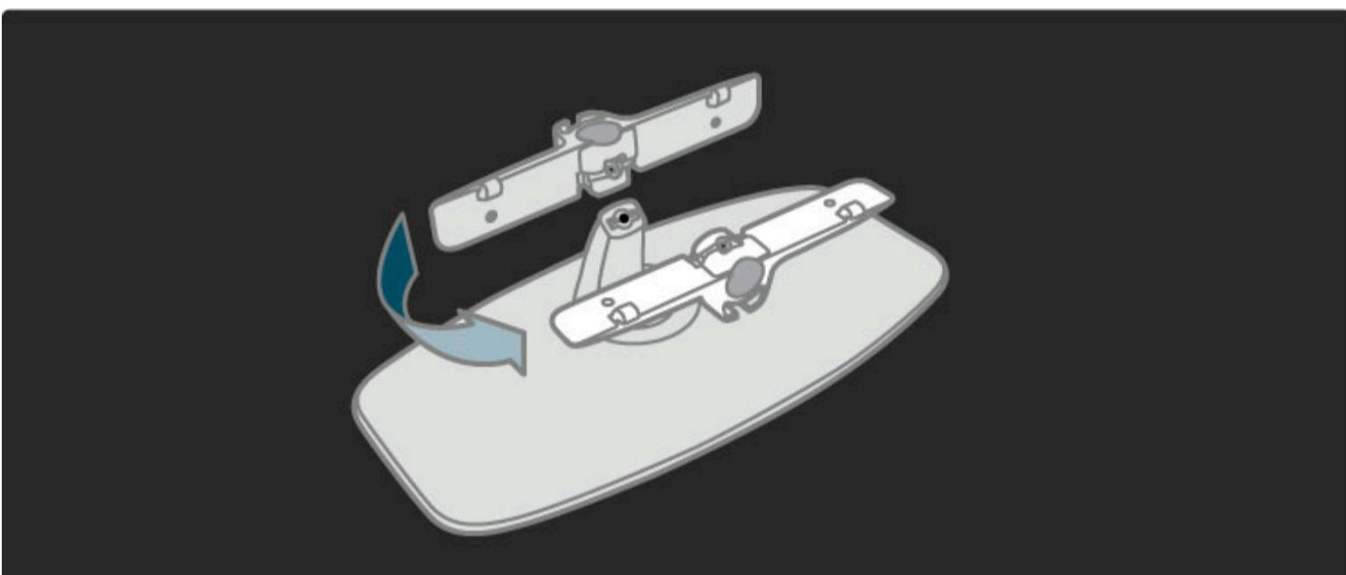
Zmeňte polohu lišty na stojane a čap dotiahnite pomocou šest'hranného kľúča.
