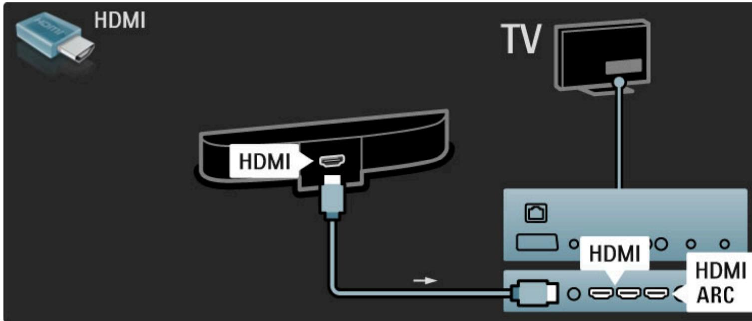
Ak na TV i zariadení používate rozhranie HDMI-ARC, nebudeť potrebovať žiadny ďalší kábel. Ak nie, tak čítajte ďalej.
