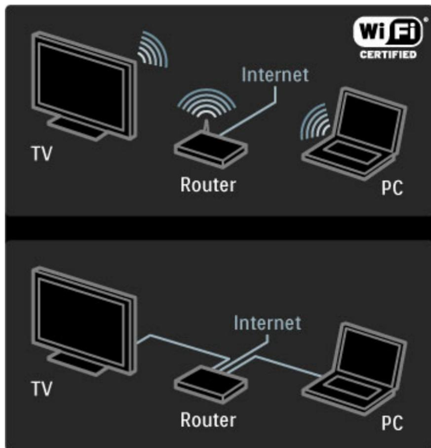
Para efectuar uma ligação com fios ao router, é necessário um cabo de rede (Ethernet).
