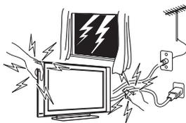
Come misura di sicurezza, durante i temporali evitare di toccare parti del televisore, il cavo di alimentazione o il cavo dell'antenna.
