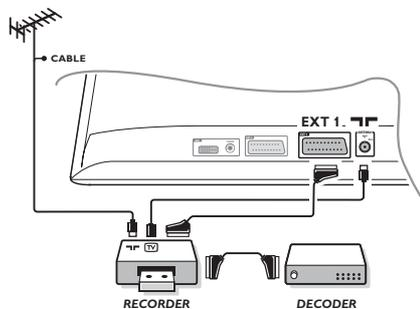
Eeguire i collegamenti necessari. Utilizzare un cordone di collegamento (presa scart) di tipo europeo di buona qualità.
