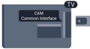
Gunakan slot Antarmuka Umum pada TV untuk memasukkan kartu CAM.
