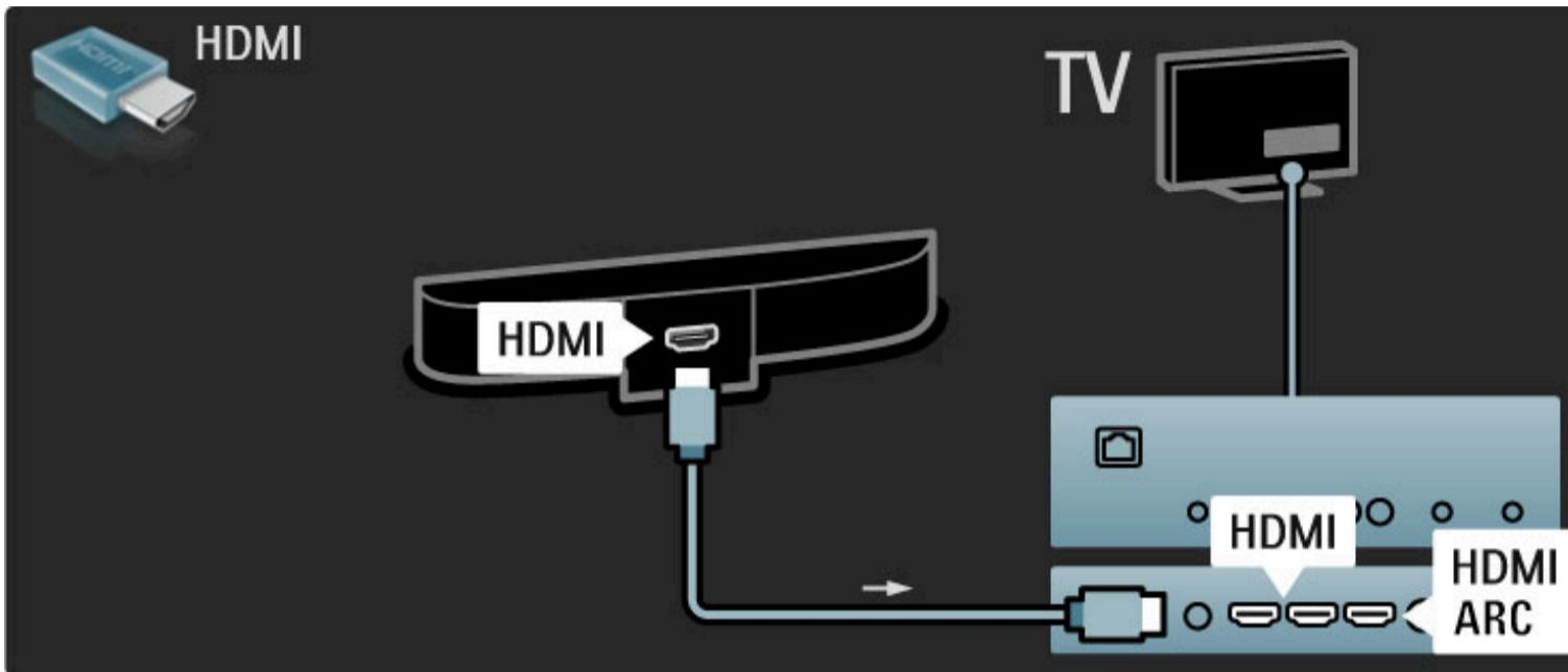
Εάν χρησιμοποιείτε συνδέσεις HDMI-ARC στην τηλεόραση και στη συσκευή, δεν απαιτείται κανένα επιπλέον καλώδιο. Διαφορετικά, διαβάστε τις οδηγίες που ακολουθούν.
