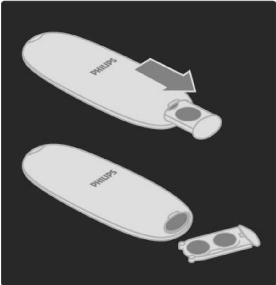
Αφαιρέστε τις μπαταρίες εάν δεν χρησιμοποιείτε το τηλεχειριστήριο για μεγάλο χρονικό διάστημα. Απορρίψτε τις μπαταρίες σύμφωνα με τις οδηγίες για τη λήξη περιόδου χρήσης. Ανατρέξτε στο κεφάλαιο **Βοήθεια > Έναρξη > Εγκατάσταση > Λήξη περιόδου χρήσης.**
