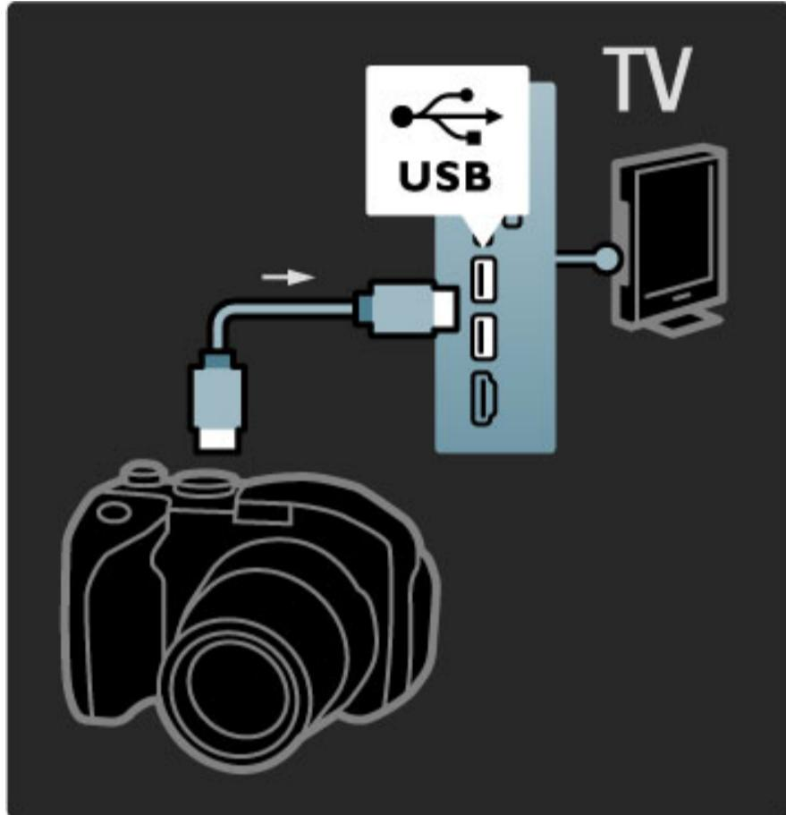
Εάν η λίστα με το περιεχόμενο της φωτογραφικής μηχανής δεν εμφανιστεί αυτόματα, ενδέχεται να χρειάζεται ρύθμιση της φωτογραφικής μηχανής σας για τη μεταφορά περιεχομένου μέσω του πρωτοκόλλου μεταφοράς εικόνων (PTP – Picture Transfer Protocol). Ανατρέξτε στο εγχειρίδιο χρήσης της ψηφιακής φωτογραφικής μηχανής.
