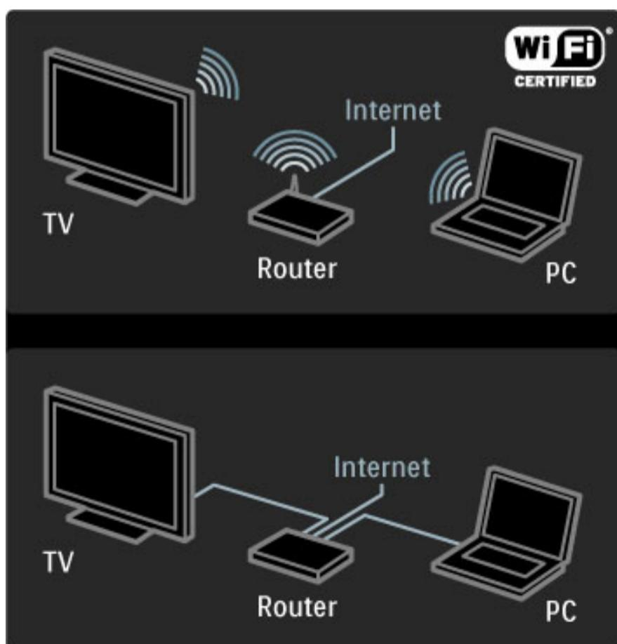
Εάν χρησιμοποιείτε ενσύρματη σύνδεση με το δρομολογητή, θα χρειαστείτε ένα καλώδιο δικτύου (Ethernet).
