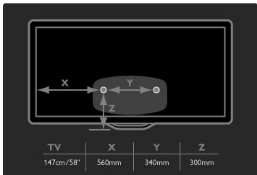
Στερεώστε τους 2 δίσκους ανάρτησης. Χρησιμοποιήστε βίδες με μέγιστη διάμετρο έως 6 χιλ.
