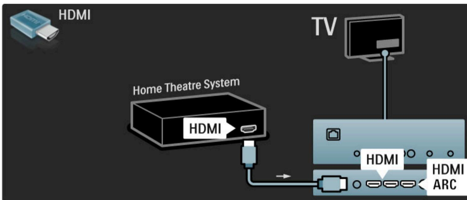
Εάν χρησιμοποιείτε συνδέσεις HDMI-ARC στην τηλεόραση και στη συσκευή, δεν απαιτείται κανένα επιπλέον καλώδιο.
