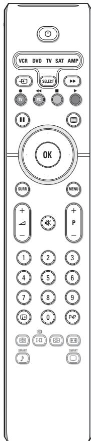
Με το τηλεχειριστήριο αυτό μπορείτε να χειριστείτε τις ακόλουθες συσκευές Philips: Τηλεόραση, Βίντεο, DVD, Δορυφορικός δέκτης (RC6), Εξωτ. Ενισχυτής (με Ραδιοφωνικό δέκτη).
