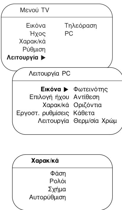
Πιέστε το πλήκτρο **MENU** για να αποκτήσετε πρόσβαση στις ρυθμίσεις που αφορούν ειδικά τη λειτουργία οθόνης PC. Χρησιμοποιήστε τα πλήκτρα κέρσορα για να διορθώσετε αυτές τις ρυθμίσεις (οι ρυθμίσεις αποθηκεύονται αυτόματα).
