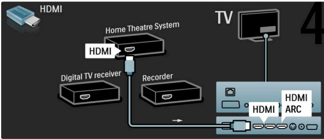
Ako želite da koristite HDMI-ARC vezu na televizoru i na uređaju, dodajte digitalni audio kabl (činč, koaksijalni).
