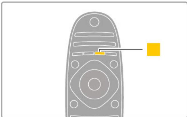
Перед выполнением инструкций из меню справки, закройте справку. Нажмите **желтую** кнопку или нажмите **↑**, чтобы закрыть справку. При следующем нажатии **желтой** кнопки, справка откроется на той странице, на которой была закрыта.
