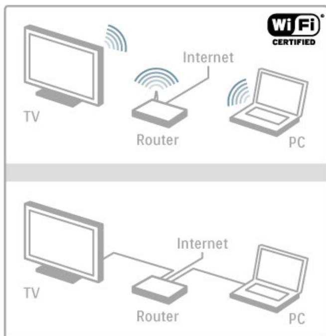
Для проводного подключения к маршрутизатору требуется сетевая кабель (Ethernet).
