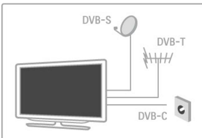
Помимо возможности приема сигналов DVB-T и DVB-C, телевизор оснащен встроенным спутниковым ресивером DVB-S/S2. Можно подключить спутниковую антенну и смотреть **цифровые спутниковые каналы**.
