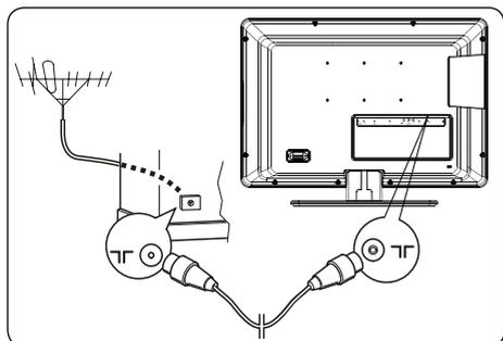
È possibile utilizzare la presa dell'antenna (75 OHM - VHF/UHF/cavo) per il collegamento di un'antenna esterna o di altro dispositivo dotato di modulatore (videoregistratore, ricevitore satellitare e così via).
