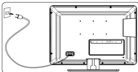
**⚠ Avvertenza:** è necessario che il televisore sia collegato all'alimentazione CA, non CC. Se la presa viene separata dal cavo, non inserirla in nessuna circostanza in una presa di alimentazione, perché sussiste il rischio di scossa elettrica.
