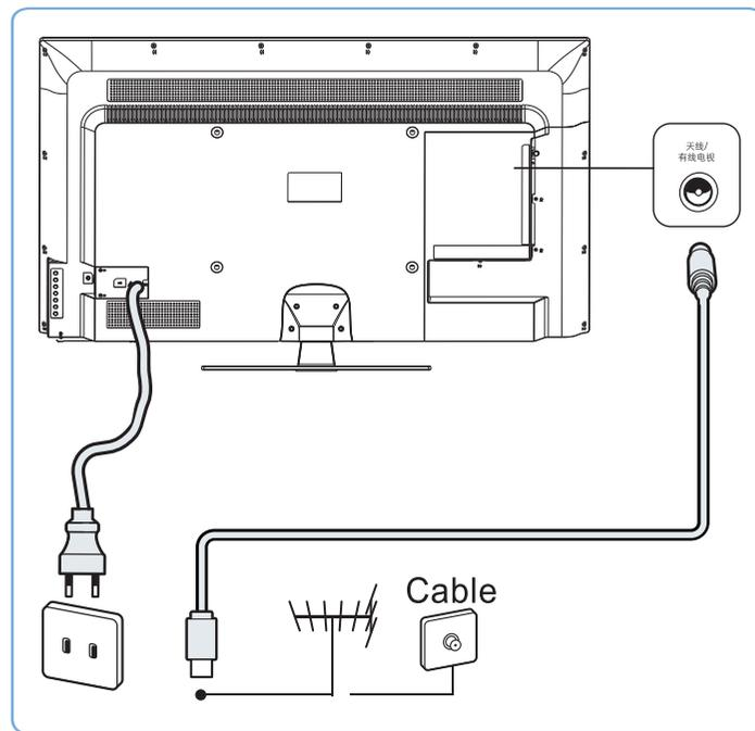
注：连接室外天线到电视机的信号接口时，请事先关闭电视机的电源。室外天线勿靠近高压市电电线，以免发生电击。雷电天气请将室外天线插头拔掉，以免发生雷击。接入本机的有线网络天线必须与保护接地隔离，否则可能引起着火等危险。
