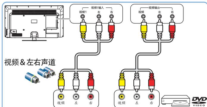
注：图中的接口仅为连接示意图，具体接口位置请自行参考实际机器接口位置连接。
