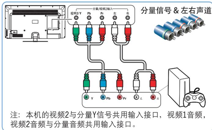
注：本机的视频2与分量Y信号共用输入接口，视频1音频，视频2音频与分量音频共用输入接口。
