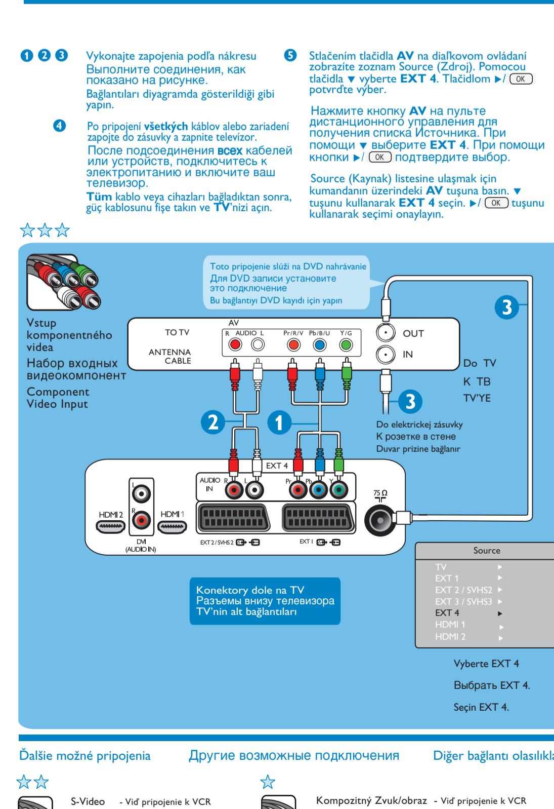
**2. Pripojenie napájania a antény/kábla**
