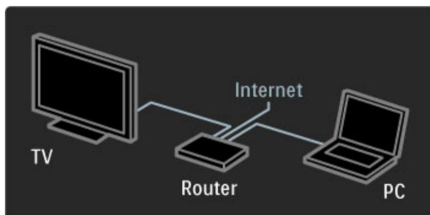
Εάν χρησιμοποιείτε ενσύρματη σύνδεση με το δρομολογητή, θα χρειαστείτε ένα καλώδιο δικτύου (Ethernet).
