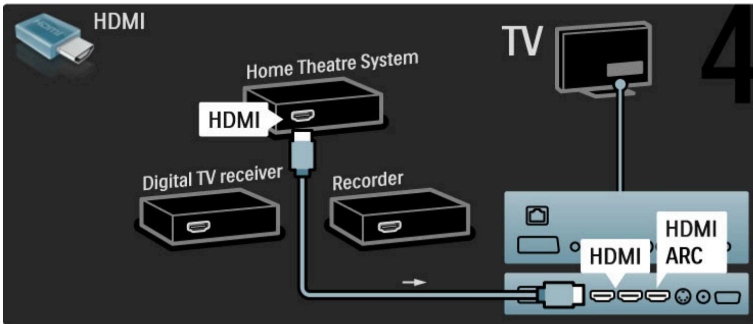
Εάν δεν χρησιμοποιήστε τη σύνδεση HDMI-ARC στην τηλεόραση και τη συσκευή, χρησιμοποιήστε ένα καλώδιο ψηφιακού ήχου (ομοαξονικό cinch).
