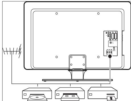
Використовуйте роз'єми на задній панелі телевізора для під'єднання антени та стаціонарних пристрой, таких як програвач компакт-дисків високої чіткості, DVD-програвач або відеомагнітофон (див. 'Під'єднання пристрой' на сторінці 46).
