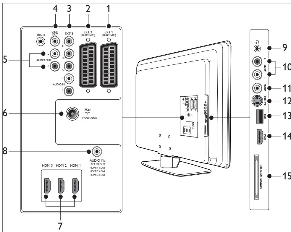
Другий роз'єм SCART. Підтримує стереофонічний аудіосигнал, композитний (CVBS) вхід та вихід, інтерфейс RGB.
