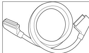
SCART поєднує аудіо- та відеосигнали в одному кабелі. Аудіосигнал є стереофонічним, тоді як відеосигнал може бути якості композитного відео або S-Video. SCART не підтримує відео високої чіткості та є аналоговим. На телевізорі є два роз'єми SCART: EXT 1 і EXT 2.
