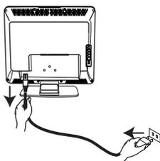
Inserire il cavo di alimentazione (fornito) nella presa di rete sotto il TV (rivolto verso il basso) e nella presa a muro.
