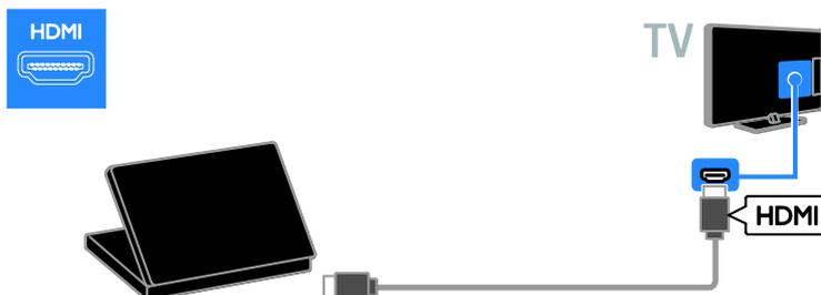
Schließen Sie den Computer über ein DVI-HDMI-Kabel und ein Audiokabel am Fernseher an.
