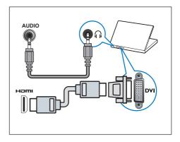
HDMI-Kabel und HDMI-DVI-Adapter
