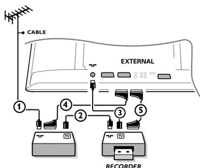
① Collegate le antenne ①, ② e ③ come indicato (soltanto se la vostra periferica ha un input/output per antenna TV). Collegate il vostro dispositivo con un eurocavo ④ o ⑤ ad uno degli euroconnettori **EXT1**, 2 o 3 per ottenere una qualità migliore dell'immagine.
