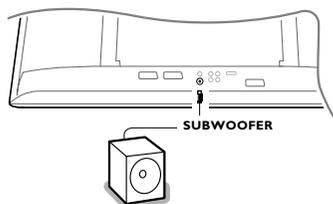
Per migliorare la riproduzione del suono della vostra TV potete collegare un subwoofer alimentato dall'esterno (fra 20 e 250 Hz).
