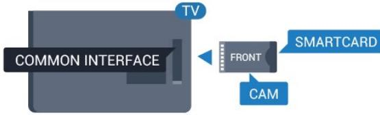
استخدم فتحة الواجهة المشتركة على التلفزيون لإدخال بطاقة وحدة CAM. مع توجيه الجهة النهائية للبطاقة نحوك، أدخل بطاقة وحدة CAM بتأن إلى أبعاد حد ممكن أن تصل إليه. اترك البطاقة في فتحها بشكل دائم.
