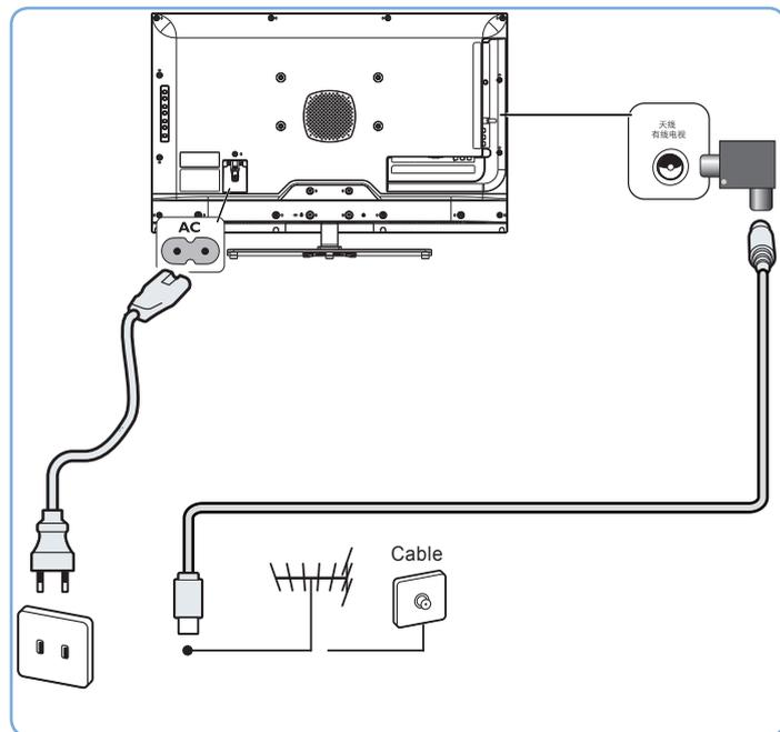
我们随机附送天线隔离器,请在安装电视的同时一并安装上天线隔离器(安装方式如上图示)。请用户在使用前务必确认天线隔离器是否有安装,若为直接接入,电视机的有线网络天线必须与保护接地隔离,否则可能会引起着火等危险。
