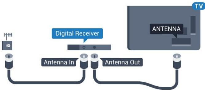
Después de conectar la antena, agregue un cable HDMI para conectar el decodificador de señal al televisor.
