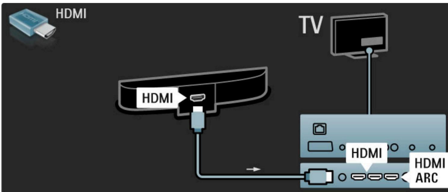
Se não utilizar a ligação HDMI-ARC, adicione um cabo de áudio digital (cinch coaxial).
