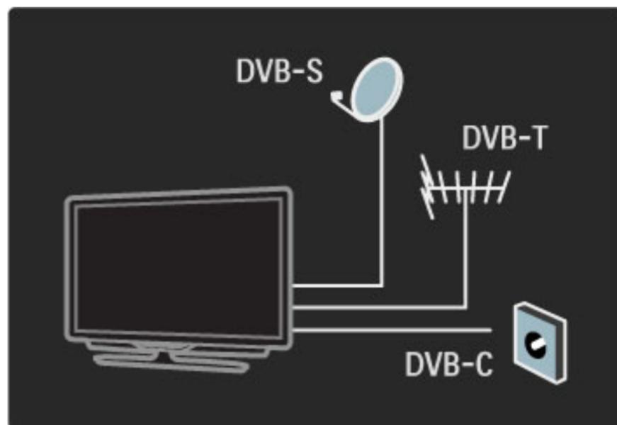
Em conjunto com o DVB-T e DVB-C, este TV possui um receptor DVB-S integrado. Pode ligar uma antena parabólica de satélite e receber **canais de satélite digitais**.
