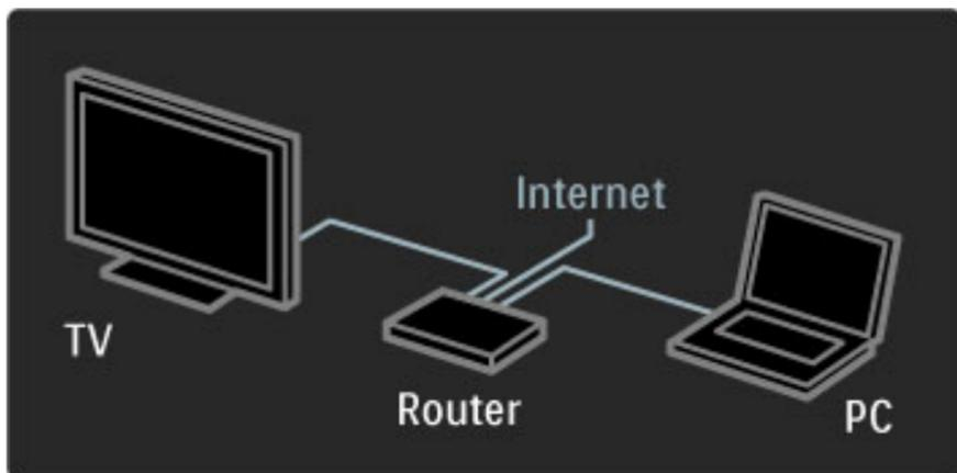
Para efectuar uma ligação com fios ao router, é necessário um cabo de rede (Ethernet).
