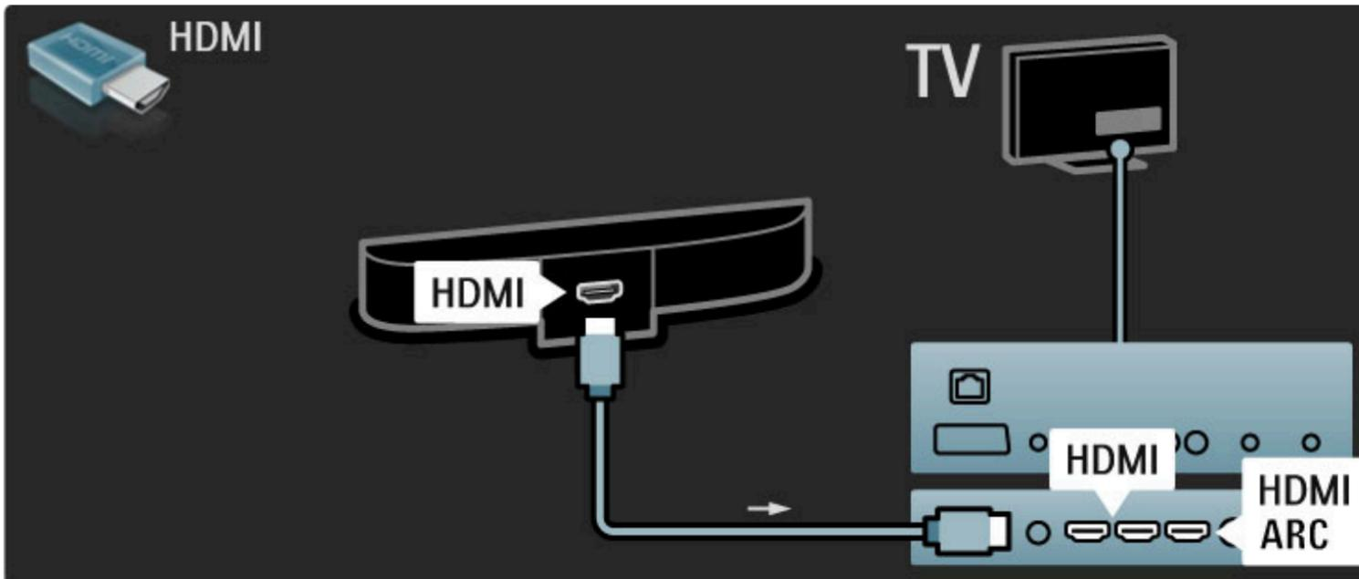
Se utilizar as ligações HDMI-ARC tanto no televisor como no dispositivo, não são necessários nenhuns cabos. Se forem necessários, continue a ler.
