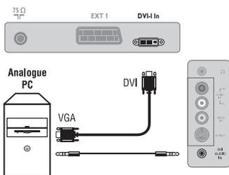
Оптимальное разрешение экрана получается, когда для компьютера выбраны настройки **1024 x 768, 60 Hz**.
