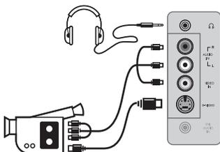
Выполните подключения, как показано на рисунке. Выберите положение **AV/S-VHS** с помощью кнопки **AV**. На монофоническом аппарате подключите звуковой сигнал к входу **AUDIO L** (или **AUDIO R**). Звук автоматически воспроизводится левым и правым громкоговорителями телевизора.
