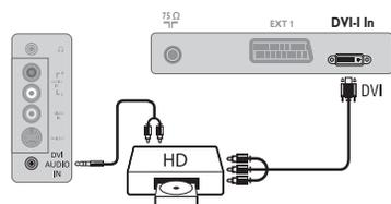
Выполните подключения, как показано на рисунке. Выберите положение **HD** с помощью кнопки **AV**. Более подробную информацию об использовании режима HD см. на стр. 11.
