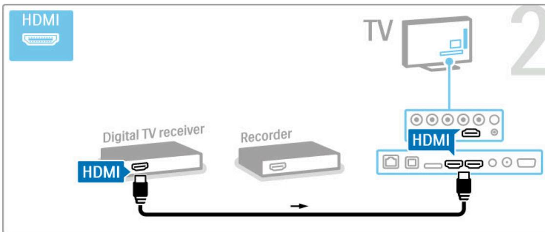
Pour finir, reliez l'enregistreur de disques au téléviseur à l'aide d'un câble HDMI.
