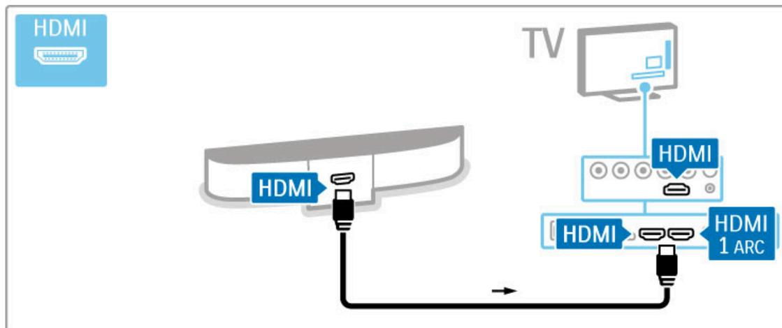
Si vous utilisez les prises HDMI-ARC sur le téléviseur et l'appareil, aucun autre câble n'est nécessaire. Dans le cas contraire, lisez la suite de cette rubrique.
