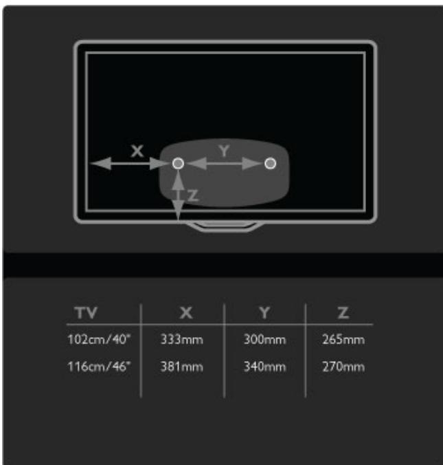
Fiksirajte 2 diska za montažu. Koristite zavrtnje čiji prečnik nije veći od 6 mm.
