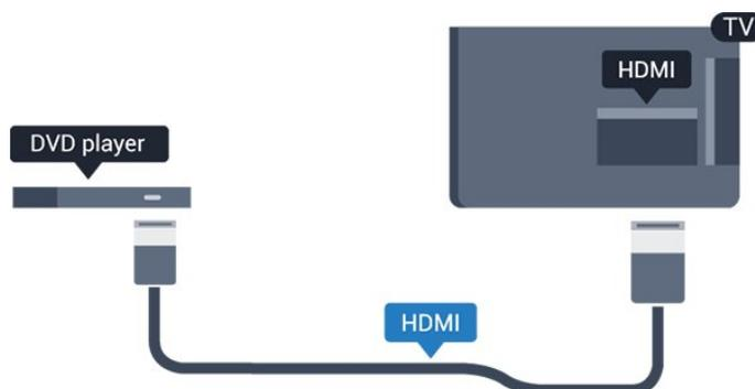
Wenn der DVD-Player über HDMI angeschlossen ist und über EasyLink CEC verfügt, können Sie den Player mit der Fernbedienung des Fernsehers steuern.
