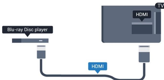
Wenn der Blu-ray Disc-Player über EasyLink HDMI-CEC verfügt, können Sie den Player mit der Fernbedienung des Fernsehers steuern.
