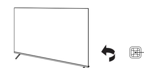
①待机下,短按开机。在任意信号源下,长按即可打开控制菜单;在菜单与智能电视界面短按作为确认键。上下左右摇摆,可在控制菜单上下左右移动光标。
