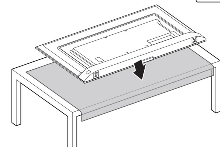
\*请将电视机底部边缘靠近台面边缘,将下巴放置于台面约5cm。
