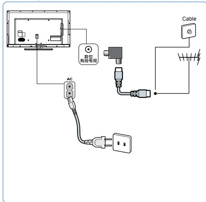
我们随机附送天线隔离器,请在安装电视的同时一并安装上天线隔离器(安装方式如上图示)。请用户在使用前务必确认天线隔离器是否有安装,若为直接接入,电视机的有线网络天线必须与保护接地隔离,否则可能会引起着火等危险。
