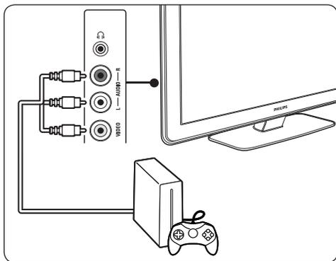
É possível ligar, de forma permanente, uma consola de jogos ou câmara de filmar a um conector HDMI ou aos conectores EXT 3 (componente), situados na parte posterior do televisor.
