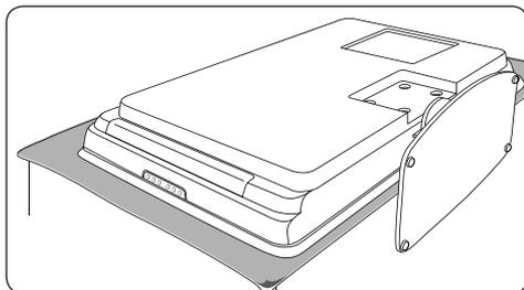
2. Com uma chave de estrelas (não fornecida), desaparafuse os quatro parafusos que fixam o suporte ao televisor.
