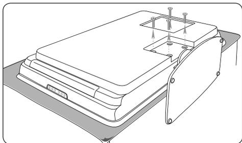
3. Separe o suporte do televisor. Coloque o suporte e os parafusos num local seguro para futura reinstalação.
