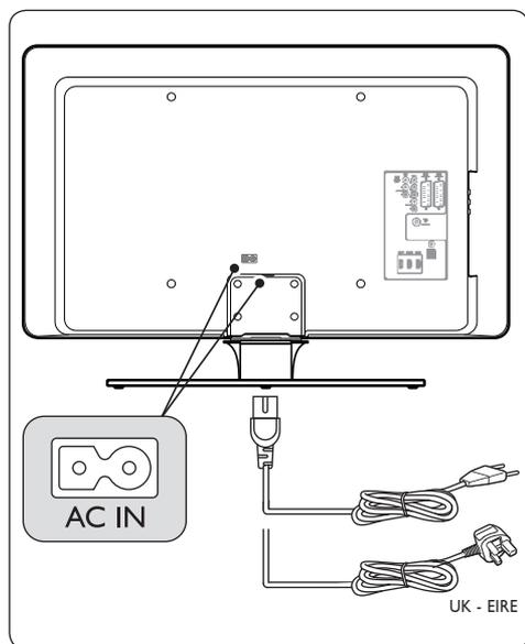
1. Identifique o conector de corrente eléctrica **AC IN** no painel posterior ou na base do televisor.
