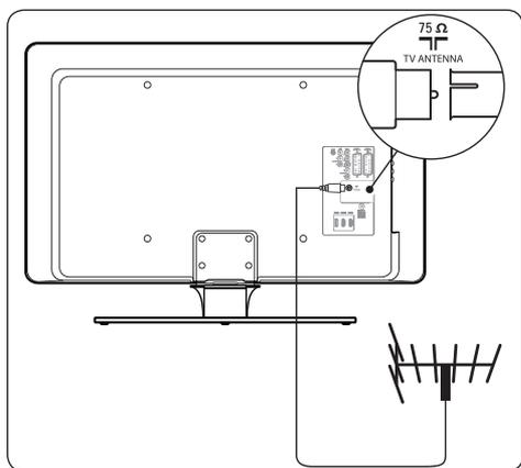
1. Localize o conector **TV ANTENNA** na parte posterior do televisor.
