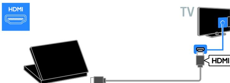
Reliez l'ordinateur au téléviseur à l'aide d'un câble DVI-HDMI et d'un câble audio.
