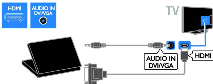
Reliez l'ordinateur au téléviseur à l'aide d'un câble VGA et d'un câble audio.
