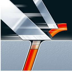
電鬚刨的雙層刀片系統可將皮膚深層的鬚髮提起並舒適地剃去。
