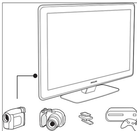
Utilizzare i connettori laterali del televisore per collegare dispositivi portatili quali videocamere o console di gioco ad alta definizione. È inoltre possibile collegare cuffie o dispositivi di memoria USB.
