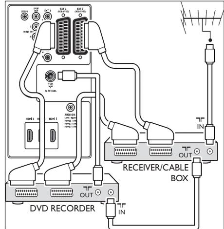
Per ricevere i canali analogici tramite l'antenna e registrare i programmi su un registratore DVD e ricevitore separato, collegare i tre cavi dell'antenna e i tre cavi SCART come illustrato:
