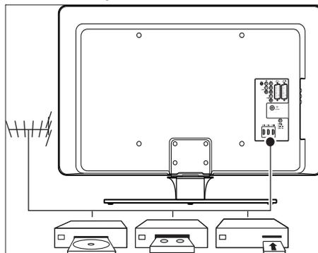
Utilizzare i connettori posteriori del televisore per collegare l'antenna e i dispositivi permanenti come un lettore di dischi ad alta definizione, un lettore DVD o un videoregistratore (vedere 'Collegamento dei dispositivi' a pagina 43).
