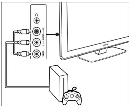
È possibile collegare una console giochi o una videocamera permanente a un connettore HDMI o EXT 3 (Component) sul retro del televisore.
