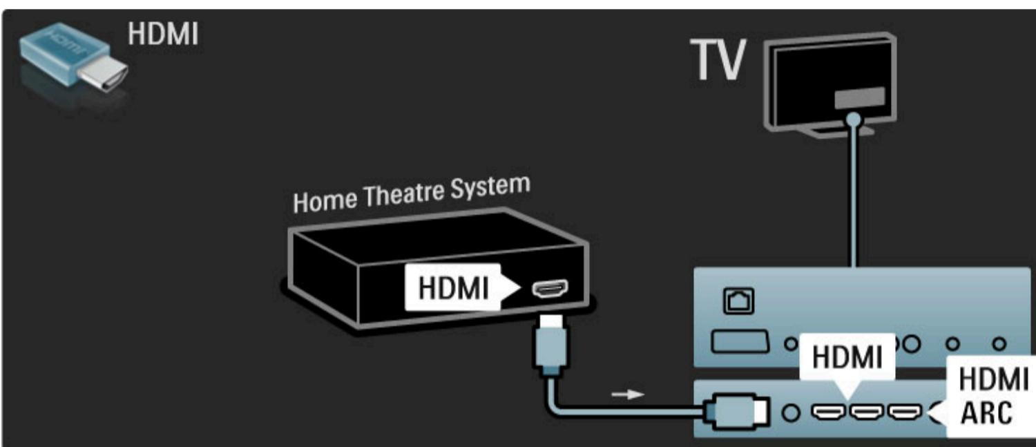
Ako koristite HDMI-ARC ulaze i na televizoru i na uređaju, ne treba vam ništa više. Ako ne koristite, nastavite čitati.
