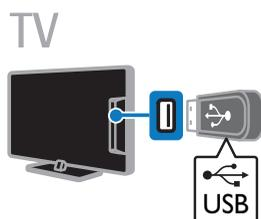
Conecte la unidad flash USB con un cable USB al televisor.
