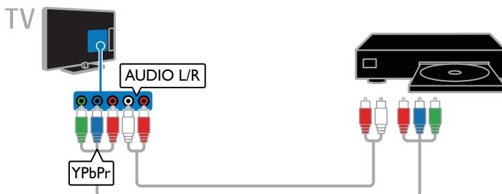
Conecte el reproductor de discos con un cable compuesto (Y Pb Pr) y un cable de audio L/R al televisor.
