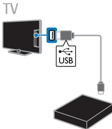
1. Conecte la unidad de disco duro USB directamente al televisor, o si desea conectar otros dispositivos USB en el futuro, conecte la unidad de disco duro USB a través de un hub USB.
