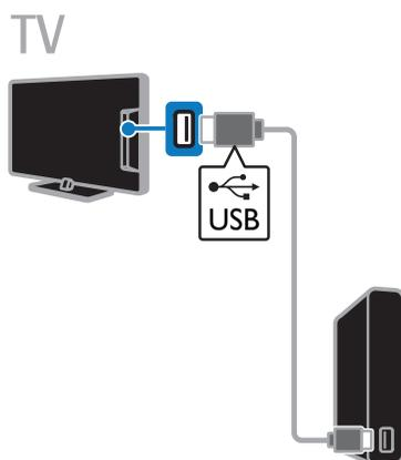
Conecte el disco duro USB con un cable USB al televisor.
