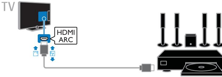
Conecte el sistema de cine en casa al televisor con un cable HDMI y un cable de audio coaxial.
