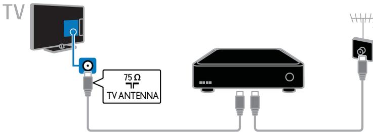
Conecte el receptor de televisión digital con un cable HDMI al televisor.
