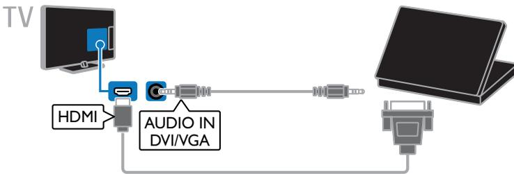
Conecte la computadora con un cable VGA y un cable de audio al televisor.
