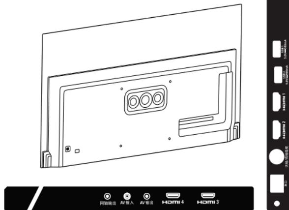
备注：由于用户装修时电源的地线与有线信号的地线电压有差异，可能造成有线信号与电视机连接处会有发热的情况，情况严重时会导致事故发生，为了避免安全事故的发生及提高观看电视的安全性，电视机内置集成天线隔离器。
