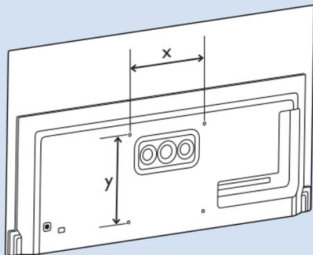
温馨提示：壁挂安装时，请先将机器壁挂锁附位置的螺丝
