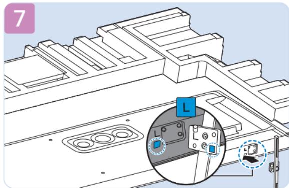
\*将底座按照图示对齐放置(注意区分左右支撑), R、L在底座上有标识。
