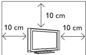
Αφήστε τουλάχιστον 10 εκατοστά ελεύθερου χώρου γύρω από κάθε πλευρά της συσκευής της τηλεόρασης για να επιτρέπεται σωστός εξαερισμός. Τοποθετήστε την συσκευή πάνω σε σταθερή, επίπεδη επιφάνεια. Ποτέ μην καλύπτετε με ύφασμα ή οποιοδήποτε άλλο υλικό τις υποδοχές για εξαερισμό της τηλεόρασης. Μπορεί να προκαλέσει υπερθέρμανση. Μην βάλετε τίποτα μέσα στις οπές εξαερισμού. Εάν κάπι ομαλό ή εύφλεκτο μπει σ' αυτές τις τρύπες, μπορεί να προκαλέσει φωτιά ή ηλεκτροπλήξια.
