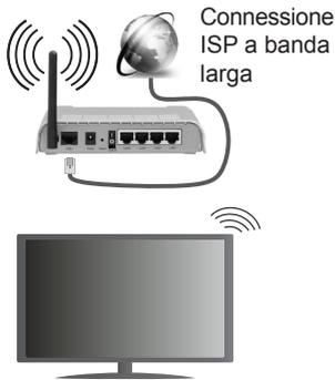
Per aumentare la larghezza di banda, è previsto un router N-wireless (IEEE 802.11a/b/g/n) con bande 2.4 e 5 GHz simultanee. Ottimizzato per uno streaming video HD più fluido e più veloce, trasferimenti file e gioco HD.
