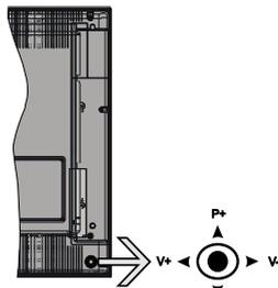
Il joystick consente di controllare le funzioni di Volume / Programma / Sorgente e Standby-On della TV.
