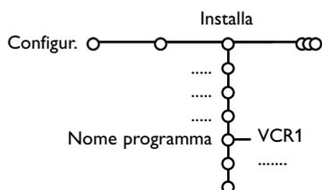
È possibile cambiare il nome trasmesso dalle società che gestisce la rete cavo, o di assegnare un nome ad un canale TV che non è ancora stato memorizzato. Potete dare un nome al massimo di 5 caratteri o cifre a ciascuno dei numeri di programma, che vanno da 0 a 99 ed agli esterni.
