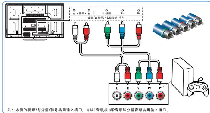
注：本机的视频2与分量Y信号共用输入接口，电脑1音频、视频2音频与分量音频共用输入接口。
