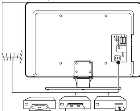
Utilice los conectores posteriores del televisor para conectar la antena y los dispositivos permanentes, como un reproductor de discos de alta definición, un reproductor de DVD o un vídeo (consulte 'Conexión de los dispositivos' en la página 43).
