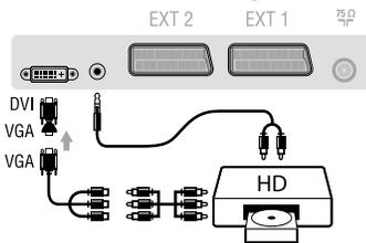
Nehmen Sie die hier abgebildeten Anschlüsse vor. Mit der Taste **AV** wählen Sie **HD** aus.
