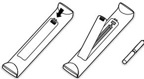
**Legen Sie die zwei R6-Batterien (geliefert) ein und stellen Sie sicher, dass deren Pole korrekt angeordnet sind.**
