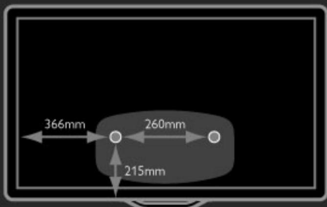
Fiksirajte 2 diska za montažu. Koristite zavrtnje čiji prečnik nije veći od 6 mm.
