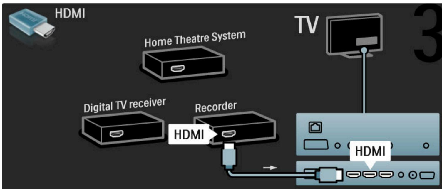
Zatim povežite sistem kućnog bioskopa na televizor pomoću HDMI kabla.
