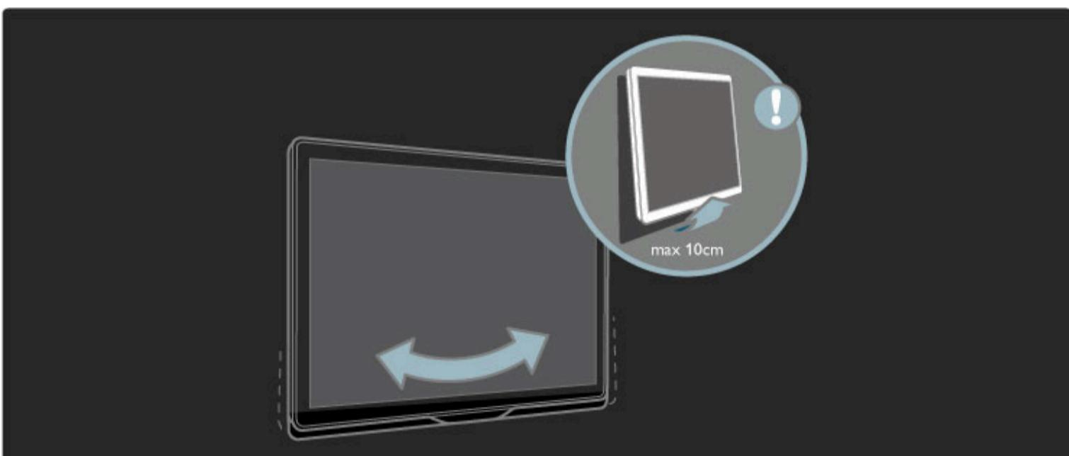
Postavite nosač postolja suprotno od položaja za montažu na zid.
