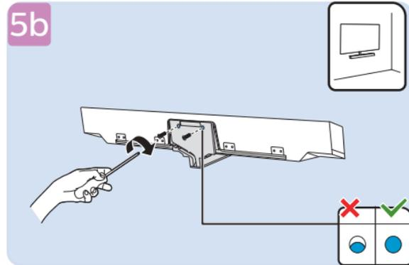
\*按照图示将音箱底部支架b的底座螺丝锁附到位。
