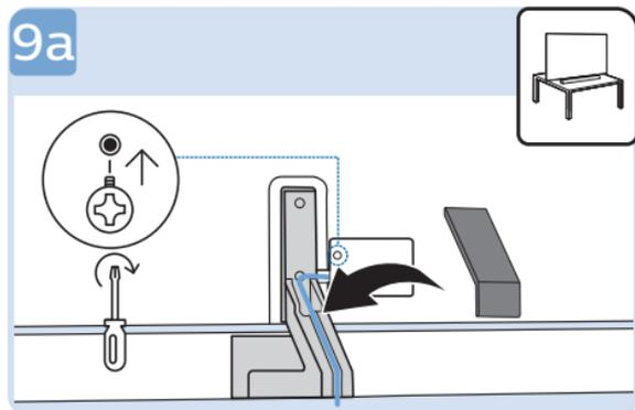
\*连接线固定好后按图示将挡板盒锁附到位，并固定好盖板。
