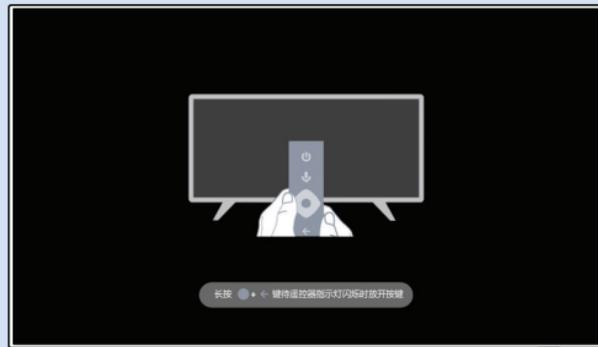
注：智能遥控器需进行配对后方可正常使用。同时按住智能遥控器的配对键（确认键+←），智能遥控器指示灯闪烁，此时松开配对键。
