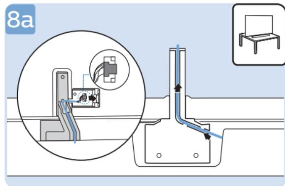
\*按照图示将音箱与电视的连接线固定。
