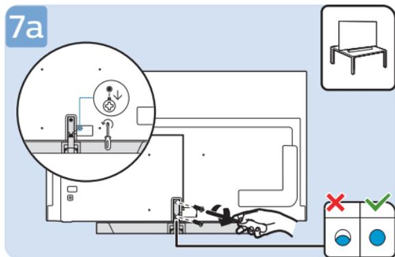
\*按照图示将音箱的底座螺丝锁附到位，并拧开电视背部的挡板盒螺丝。
