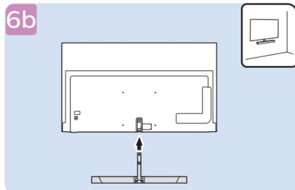
\*将安装好后的音箱支架b按照图示对齐放置。
