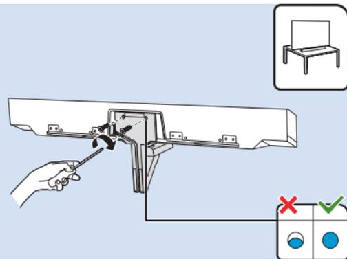
\*按照图示将音箱底部支架a的底座螺丝锁附到位。
