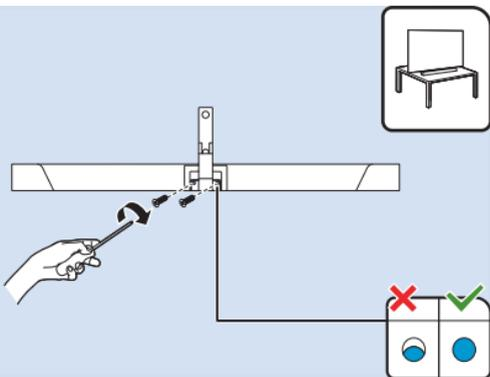
\*按照图示将音箱背部支架a的底座螺丝锁附到位。
