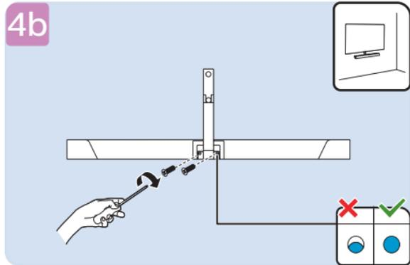
\*按照图示将音箱背部支架b的底座螺丝锁附到位。
