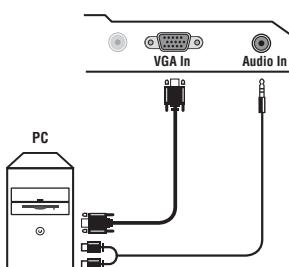
Collegare l'uscita del monitor del computer all'ingresso **PC VGA In** del televisore. Collegare l'uscita audio **Audio out L e R** del computer all'ingresso **Audio in (PC)** del televisore.
