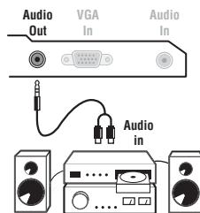
For å koble til et stereoanlegg bruker du audiokabel. Kabelen skal gå mellom **Audio out**-utgangene på TV-apparatet og inngangen "AUDIO IN" "L" og "R" på stereoanlegget.
