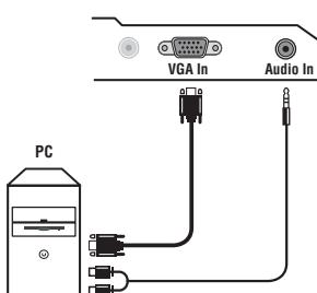
Schließen Sie den Ausgang der Grafikkarte des Computers an die PC-Eingangsbuchse des Fernsehgeräts an. Verbinden Sie den rechten und linken Audioausgang **Audio out L** und **R** der Soundkarte mit den Audio-Eingangsbuchsen **Audio in (PC)** des Fernsehgeräts.
