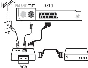
Realice las conexiones indicadas enfrente. Utilice un cable Euroconector de buena calidad.
