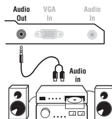
Om een hi-fi systeem aan te sluiten, dient u een audiokabel te gebruiken en de **Audio out** uitgangen van het TV toestel aan te sluiten op de ingangen "AUDIO IN" "L" en "R" van de versterker van uw hi-fi.
