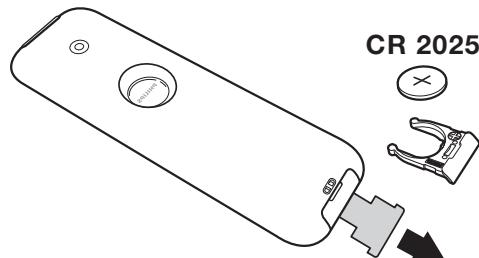
Retirer le film d'isolation de la pile pour activer la télécommande.
