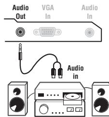
Om TV-apparaten skall anslutas till en hifi-anläggning används en ljudkabel. Anslut ljuduttaget **Audio out** på TV-apparaten till « **AUDIO IN** » « **L** » och « **R** » på hifi-anläggningen.
