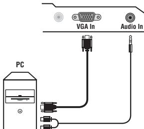
Ligue a saída monitor do seu computador à entrada **PC VGA In** do televisor.
