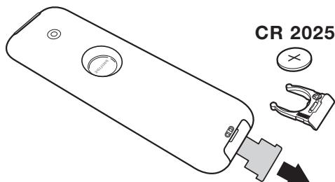
Verwijder de beschermfolie van de batterij om de afstandsbediening te activeren.
