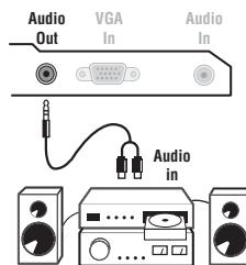
Para conectarse a un sistema hi-fi, utilice un cable de conexión audio y conecte la salida de sonido **Audio out** del televisor a la entrada "AUDIO IN" "L" y "R" de su amplificador hi-fi.
