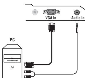
Slut computerens skærmudgang til indgangen **PC VGA In** på fjernsynet. Slut lydudgangen **Audio out L** og **R** på computeren til indgangen **Audio in (PC)** på fjernsynet.
