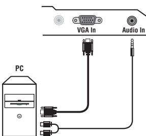
Koble datamaskinenes skjerm til inntaket **PC VGA In** på TV-apparatet. Koble datamaskinenes lyduttak **Audio out L** og **R** til inntaket **Audio in (PC)** på TV-apparatet.
