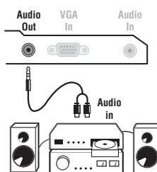
Zum Anschluß an eine Hifi-Anlage benutzen Sie ein Audio-Verbindungskabel. Verbinden Sie die Audioausgang **Audio out** des Fernsehgerätes mit einem Eingang "AUDIO IN" "L" und "R" des Verstärkers.
