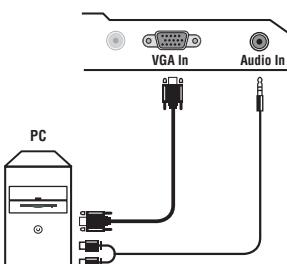
Sluit de schermuitgang van uw computer aan op de **PC input VGA In** ingang van de TV. Sluit de **Audio out L** en **R** uitgangen van de computer aan op de **Audio in (PC)** ingang van de televisie.
