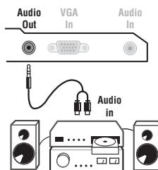
Pour le raccordement à une chaîne Hi-fi, utilisez un cordon de liaison audio et connectez la sortie son **Audio out** du téléviseur à une entrée "AUDIO IN" "L" et "R" de la chaîne Hi-fi.
