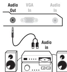
Para efectuar uma ligação a um sistema sonoro de alta fidelidade, utilize um cabo de conexão áudio, e ligue a saída som Audio out do televisor às entradas "AUDIO IN" "L" e "R" do amplificador do seu sistema de alta fidelidade.
