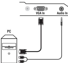
Koppla bildskärmsutgången på din dator till ingången **PC VGA In** på TV-apparaten. Koppla ljuduttaget **Audio out L** och **R** på datorn till ingången **Audio in (PC)** på TV:n.
