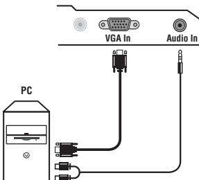
Conecte la salida para monitor del ordenador a la entrada **VGA In** del televisor. Conecte la salida de sonido **Audio out L y R** del ordenador a la entrada **Audio in (PC)** del televisor.
