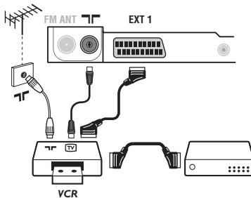
Eseguire i collegamenti necessari. Utilizzare un cordone di collegamento (presa scart) di tipo europeo di buona qualità. Se il vostro videoregistratore non ha una presa scart, l'unico collegamento possibile rimane quello per mezzo dell'antenna. Bisognerà quindi cercare il segnale di prova del vostro videoregistratore e attribuirgli il numero di programma 0 (vedi capitolo "memorizzazione manuale" a pag. 5). Per far apparire l'immagine del videoregistratore, premere .
