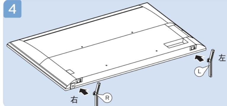
\*将底座按照图示对齐放置(注意区分左右支撑), R、L在底座上有标识; 7
